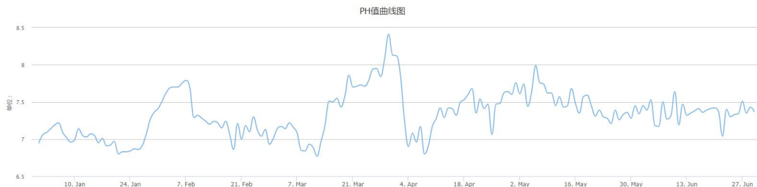
图 3.4-3 废水 pH 在线波动图（2023.01-2023.11）
